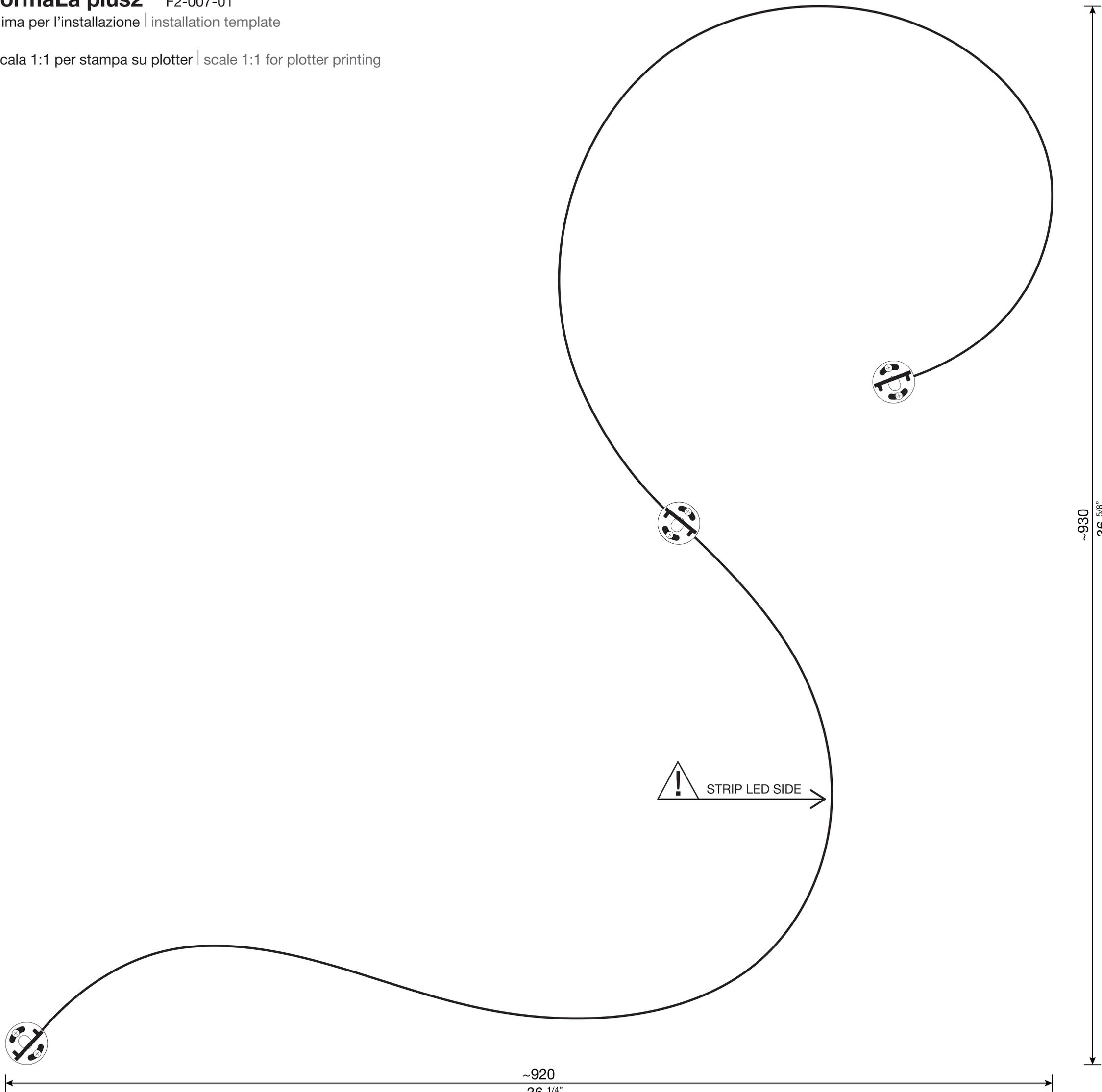
l'elasticità del materiale può causare lievi differenze di forma rispetto al disegno | material elasticity may cause slight differences between shape and template
